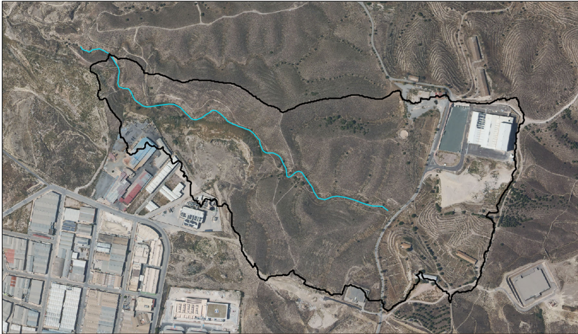
Cuenca vertiente del cauce analizado sobre ortofoto actual
